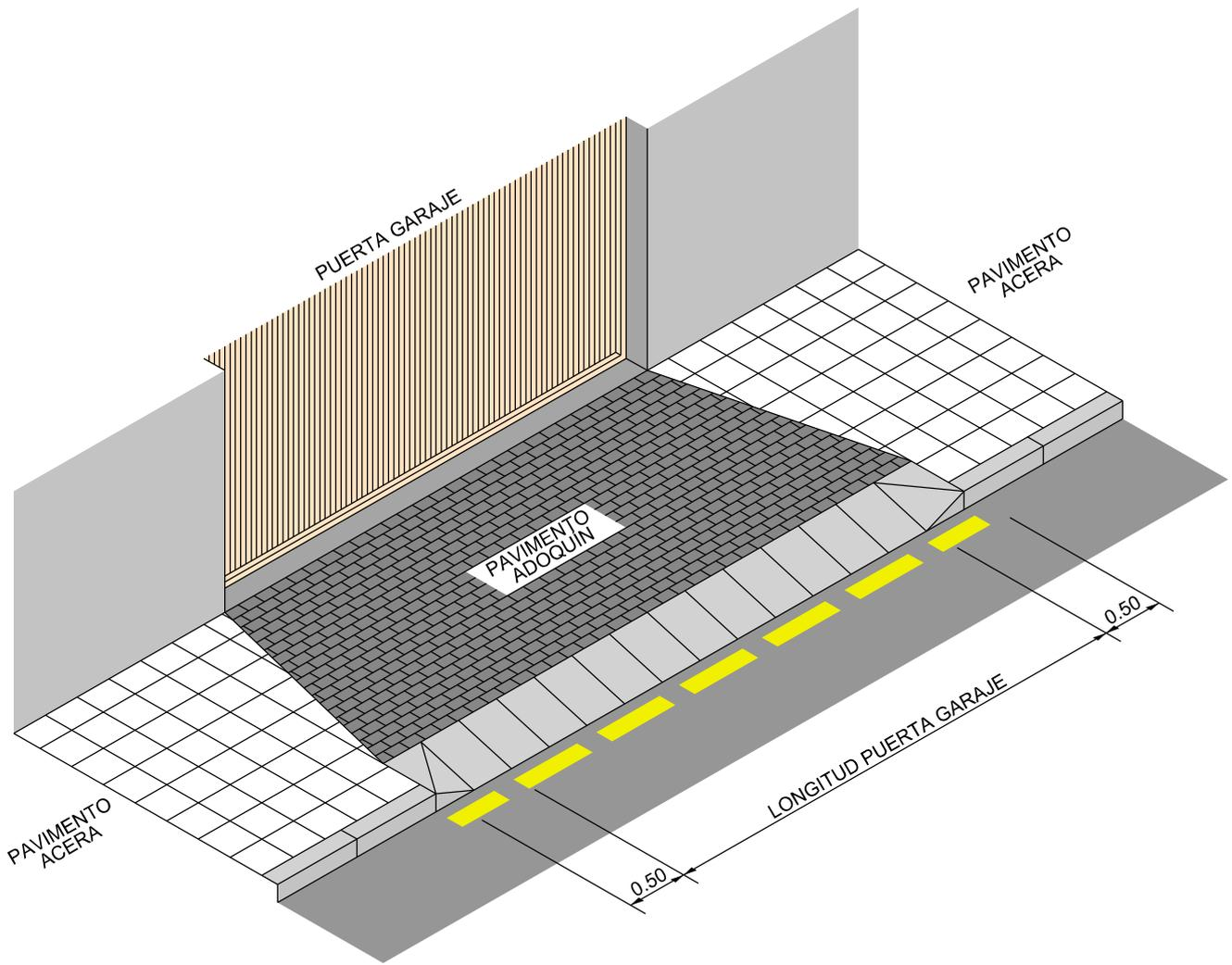
SEÑALIZAR LÍNEA AMARILLA DISCONTINUA, EN TODO EL ANCHO DE LA RAMPA
