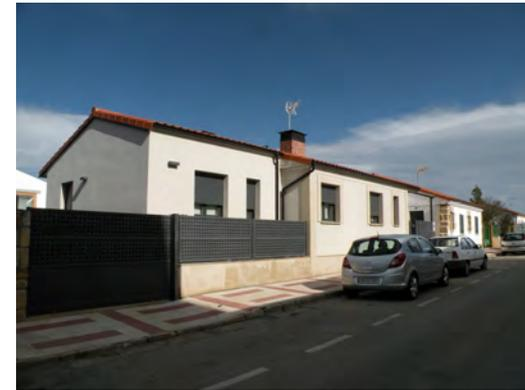
Cubrición total o parcial de porches y zaguanes en distintos materiales, tales como uralita, chapa roja, etc., y cierres de porches con carpinterías de alumbrío, rompiendo la uniformidad del conjunto así como la configuración volumétrica del prototipo original.
